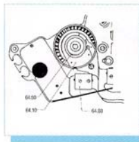
图6 行程控制凸轮机构NSW和POT
