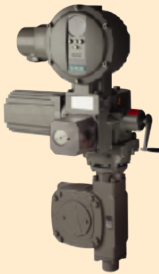
角行程执行机构 2SA5...+GS.../GF... 角行程执行机构由多回转执行机构和与之装配成一体的蜗轮减速箱两部分组成(减速箱分成直连式GS和底座曲柄式GF两种)。其主要参数为关断力矩(Nm)和全行程时间(秒/90°)。
