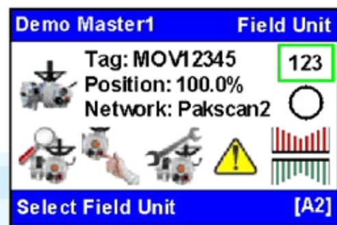
液晶画面 — MOV制御及び監視画面
