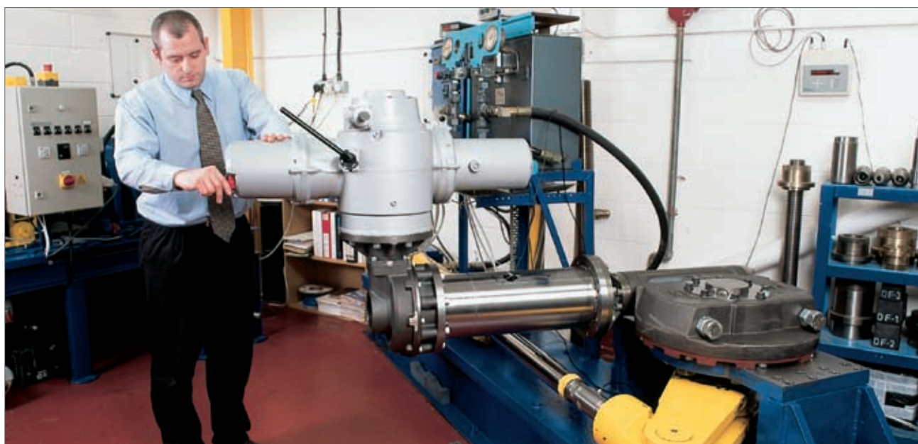
Испытание на прочность прототипа подводного редуктора
