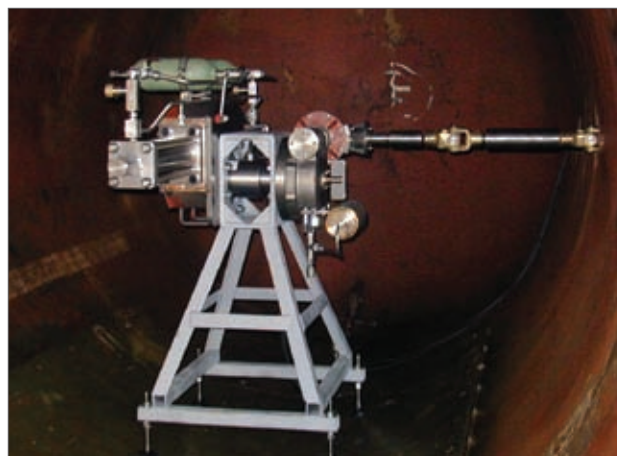
Гидростатическое испытание подводного редуктора
