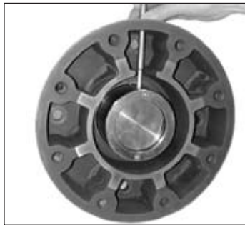
Rys. 5.9 Dokręcanie śruby dociskowej elementu ustalającego
