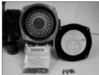
Rys. 7.1 Zdejmowanie pokrywy zacisków – siłowniki Syncropak
