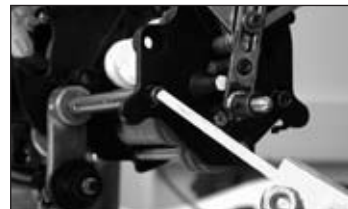
Rys. 10.2 Śruby ustalające przedniej płyty potencjometru AOP
