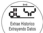
Pantalla de extracción del registrador de datos
