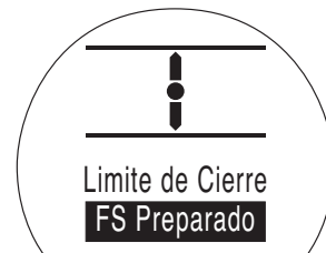
Pantalla del actuador IQT con batería de seguridad
