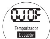
Interruptor Temporizador Desactivado
