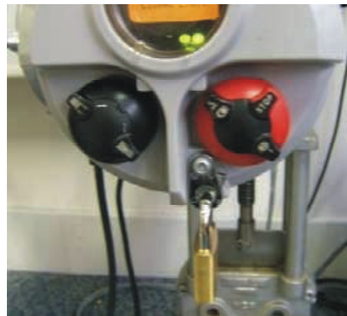
Kuva 3 IQ/IQT-ohjausvalitsin kiinnitetty munalukolla "Remote"-asentoon
