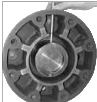
Fig. 15 Apriete el Tornillo de Fijación del Retenedor
