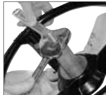
Fig. 23 - 2 Llaves de Tuerca para el Tope inferior
