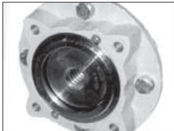
Fig. 4 Drivbussning av brons monterad i den tryckupptagande basen
