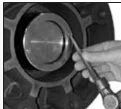
Fig. 4.6 Remoção do retentor
