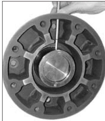
Fig. 4.12 Aperto do parafuso de fixação do retentor
