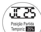
Temporizador configurado para começar a pulsar quando o fechamento da válvula alcançar 25% de abertura
