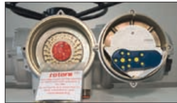
Fig. 6.2 - Atuador contendo a Ferramenta de Configuração Pro da Rotork.
