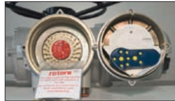
Afb. 6.2 Aandrijving met Rotork Setting Tool Pro
