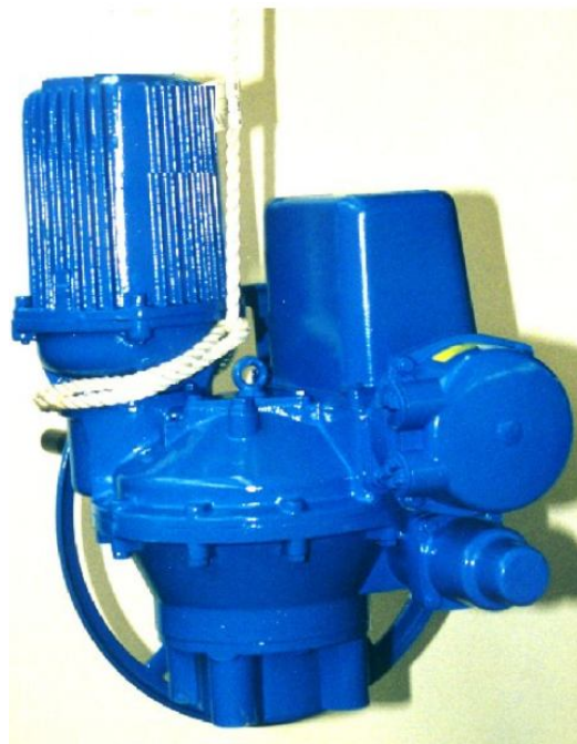
图 4: 通过吊车对执行器搬运
