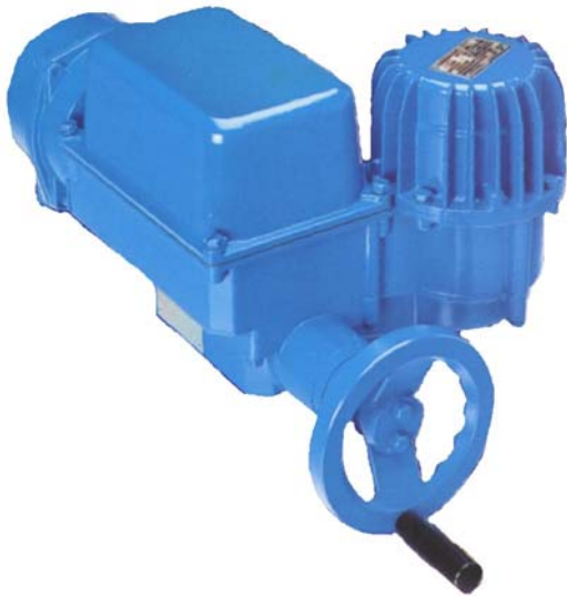
不带整体控制单元的执行器 多回转 D30-D1000 Max. 1000 Nm 部分回转 DP30-DP1599 Max. 1600 Nm 直行程 D15-D80 Max. 80 kN
