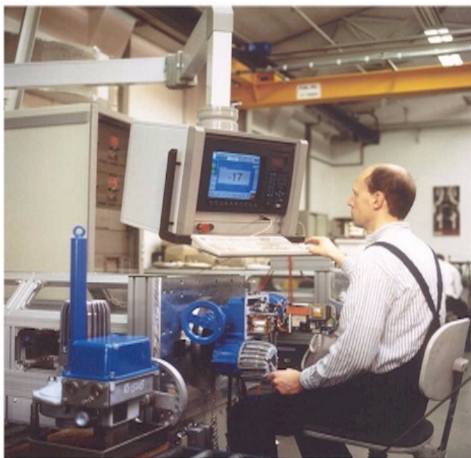
出厂前对执行器进行检验
