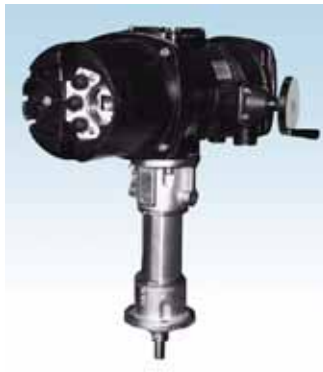
直行程执行机构 M8... + L8... 直行程执行机构由多回转执行机构和与之装配成一体的直线推进装置两部分组成
