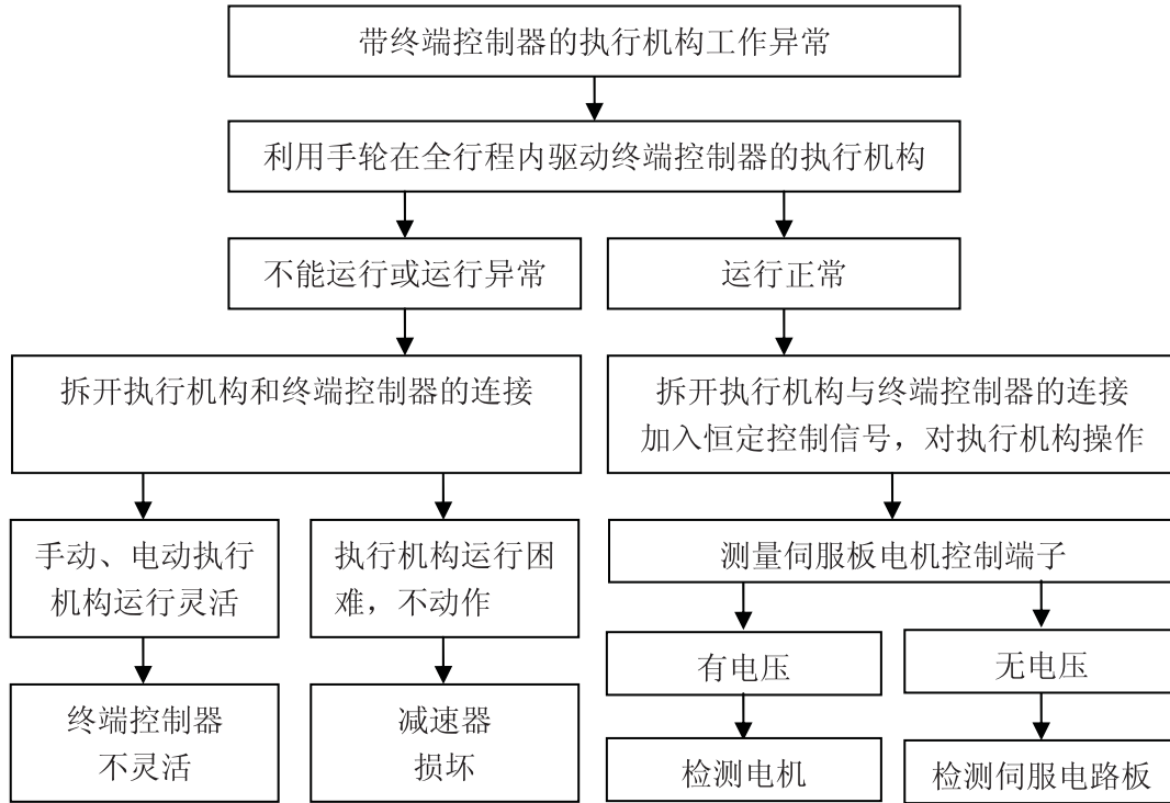
图 14 故障诊断流程
