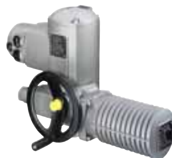
部分回转电动执行器 SG 05.1 - SG 12.1 扭矩 100 至 1 200 Nm 90 度转动时间 4 至 180 秒
