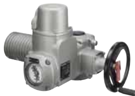
多回转电动执行器 SA 07.1 - SA 16.1 / SA 25.1 - SA 48.1 扭矩从 10 至 32 000 Nm 速度为每分钟 4 至 180 转
