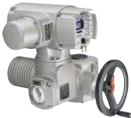
多回转电动执行器 SA/SAR 配备 AUMATIC 控件 扭矩从 10 至 1 000 Nm 速度为每分钟 4 至 180 转
