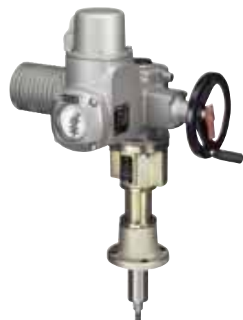
多回转电动执行器 SA/ SAR 配备线性推力单元 LE 推力 4 kN 至 217 kN 最大行程 500 毫米 线性速度 为每分钟 20 至 360 毫米
