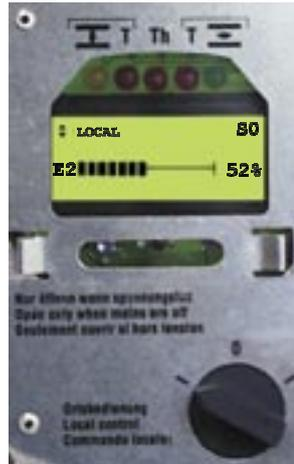
现场控制单元上的选位开关(图 P3)设在“现场”位置。
